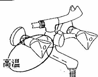
器具の左側は給水側のため高温になっています。金具（金属）の表面に直接触れないようにしてください。
