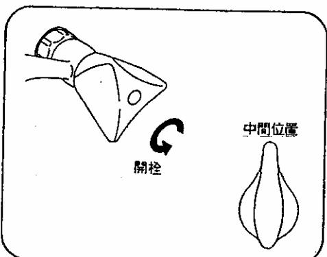
※再通水前には水抜栓を閉め、開閉ハンドルを閉め、切換ハンドルを吐水側にもどしてください。
