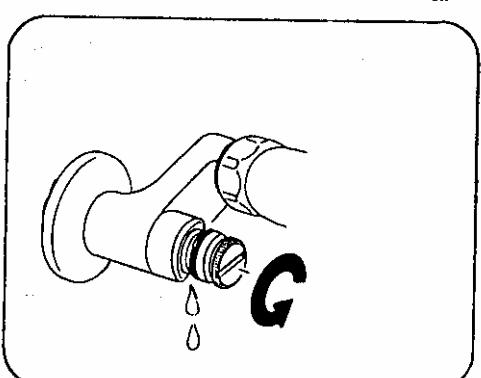
★ご注意：冬季、水栓内部の水が凍結すると、本体部分および部品が破損する可能性がありますので必ず水抜きを実行してください。
