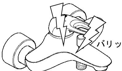
凍結破損で漏水し、家財などを濡らす財産損害発生のおそれがあります。
