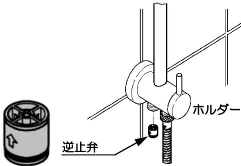
3. 切換レバーを右に回して、ハンドシャワー側の水を抜きます。
