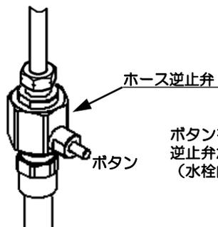
ボタンを押すと逆止弁が開放されます。(水栓内の水を抜けるようになります)
