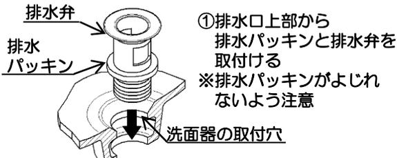
①排水口上部から排水パッキンと排水弁を取付ける
