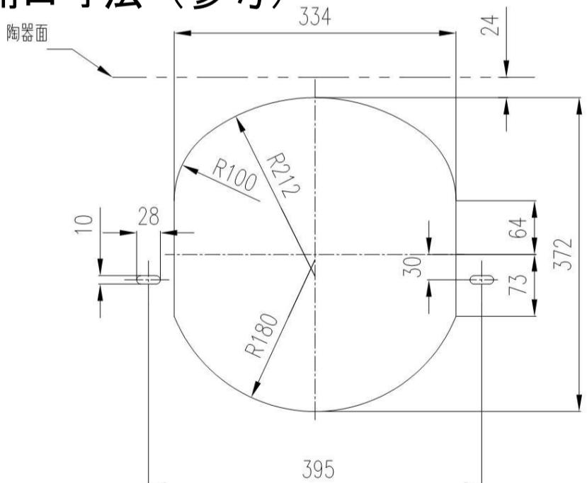
\* 同梱部品にて固定する際は、カウンター締結部の厚みが 25 mm 以下になるよう設定してください。
