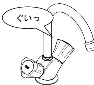
器具が破損し、けがをしたり、漏水で家財などを濡らす財産損害発生のおそれがあります。
