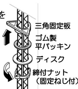
3. 締付ナットの固定ねじ(M5x12)を交互に最後までねじこみます。
