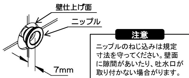
5. 化粧プレートに吐水口を取付け、ビスで固定します。
