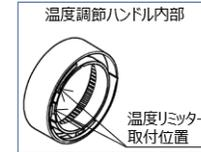
(4900200M) は、サーモ水栓用リミッター5個と、埋込サーモ用リミッター5個入りです。
