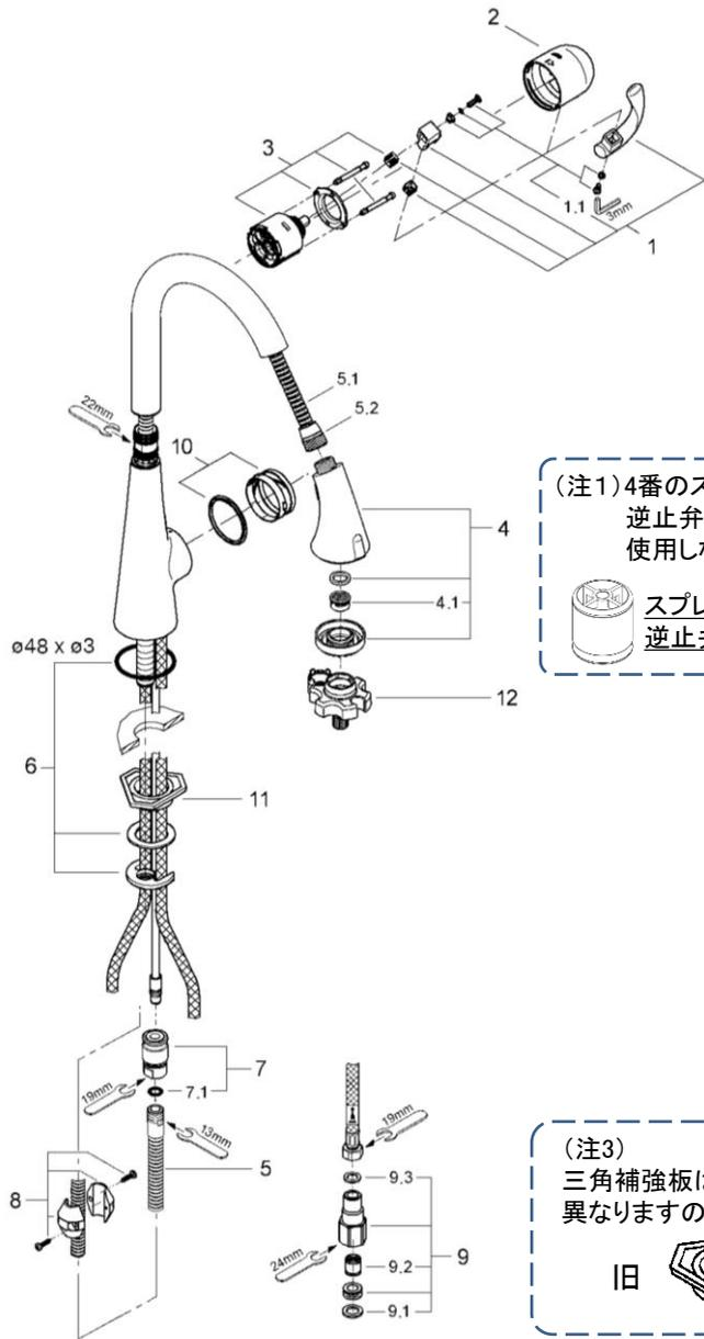
(注1) 4番のスプレーヘッドを交換の際、逆止弁が同梱されていますが使用しないでください。
