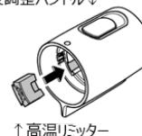
※高温リミッター取付け時の最高温度は約43°Cですが、給湯温度により変動があります。
