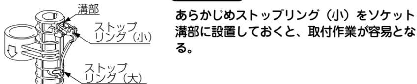
あらかじめストップリング(小)をソケット溝部に設置しておくと、取付作業が容易となる。
