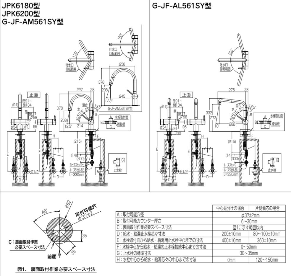
※湯水の止水栓（配管）の間の範囲（口部）には、分岐配管や障害物がないようにしてください。ホースの出し入れの障害になります。（口部）はおおよそのホース取り回し範囲を示します。
