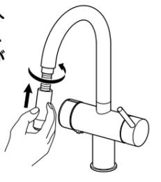
吐水口の回転角度は、出荷時に120°、または150°に設定していますが、回転規制部材を交換することで80°へ変更することができます。
