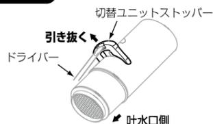
3. 切替ユニットを外して、ストレーナーに付いたゴミを歯ブラシなどで洗剤を使わずにこすり落とす。
