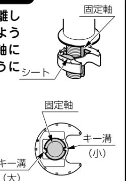
5. ナットをさらに締め続け、音が鳴り始めてから1/2回転以上増し締めする。(締付トルク10N・m程度)
