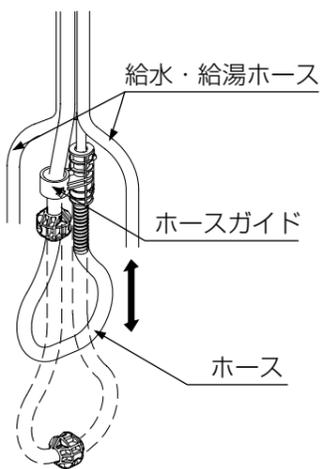
2. ホースが引出し、配管スペース、止水栓などに干渉する場合、吐水管を軽く曲げて、ホースの干渉を避ける。
