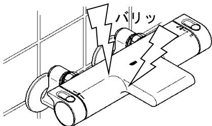
凍結破損で漏水し、家財などを濡らす財産損害発生のおそれがあります。
