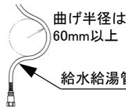
給水・給湯管を曲げる場合は、曲げ半径60mm以上確保してください。
