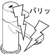
凍結破損で漏水し、家財などを濡らす財産損害発生のおそれがあります。
