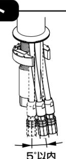
※曲げすぎると、配管を傷つけ漏水の原因となります。
