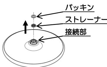
③ドライバー等の細い工具を使用し接続部から流量リミッターを取り外します。
