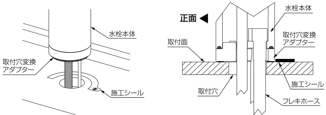
4.施工シールの②に合わせて水栓の取付位置を調整し、施工する。
