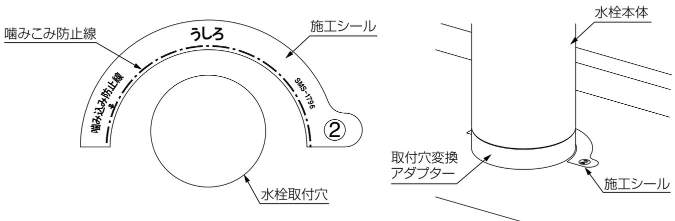
5.②の噛みこみ防止線に取付穴変換アダプターが触れていないことを確認後、施工シールを剥がす。
