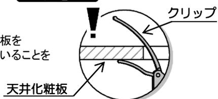
②配管と反対側の本体を固定した状態で配管を挟んだりしないことを確認し、本体を天井にしっかり押し当てて固定します。
