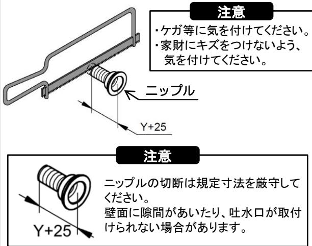
3. ニップルの接続ネジ部にシール剤(シールテープ等)を使用し、12mm六角レンチで配管に右回しにねじ込みます
