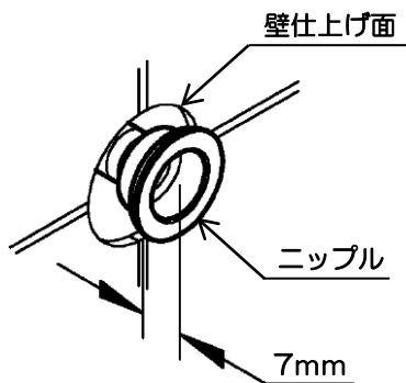
5. ニップルに化粧プレートと吐水口を取付けます。吐水口の向きを確認し、埋込本体部にしっかりと差し込み、化粧プレートの下側に固定ビスを取り付けます。
