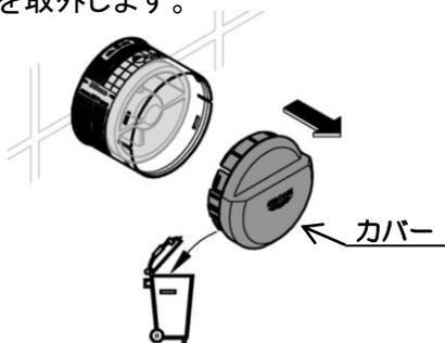
2. 給水・給湯の止水栓が閉じていることを確認しプラグを取外します。
